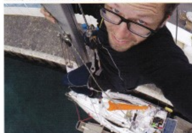
Jacht Szymona ma wzmocniony maszt i pogrubione olinowanie stałe.
