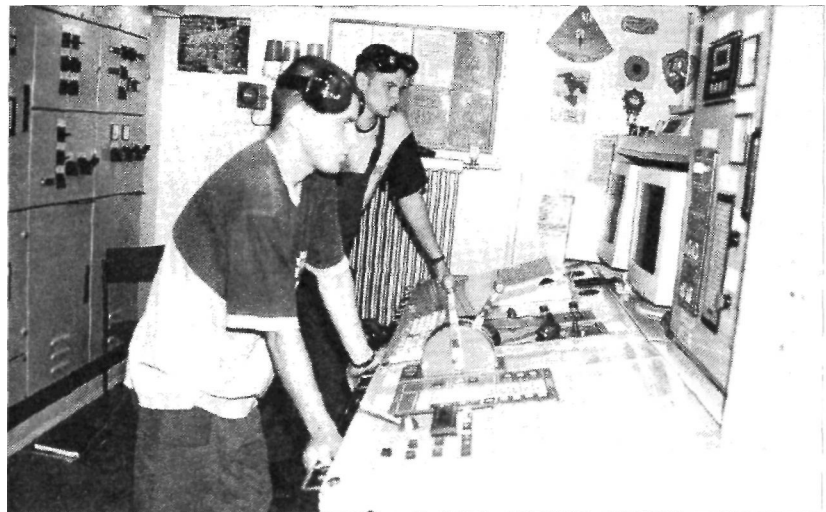
Głęboko pod pokładem jest centrum sterowania siłownią. Tu także królują komputery, nadzorujące pracę silnika głównego i agregatów, ale sterowanie pracą maszyny zwykle przekazywane jest na mostek.
